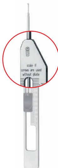
Abb. 8 b: Kommt eine nicht kanülierte T-Drive-Schraube zum Einsatz, so wird der Tiefenmesser (26-945-00) verwendet. Da dessen Hülse auf der Platte aufsitzt, muss zur korrekten Längenmessung noch die Profilhöhe der Platte addiert werden. Es ist die Seite des Tiefenmessers maßgeblich, die nur die Schraube darstellt.
